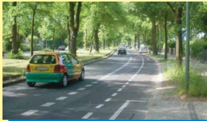
Foto 2 - Dahlem (Berlino). In assenza delle dimensioni minime per segnare le due corsie si è correttamente inserita la fascia ciclabile, oltre ad alcuni stalli di sosta
