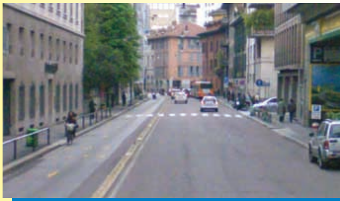
Foto 8 - Milano, via Visconti di Modrone. La corsia controsenso protetta da cordolo invalicabile è ampia solo 3,5 metri ma è percorsa da molti ciclisti in fortissimo conflitto con gli autobus.
